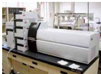
液体クロマトグラフ質量分析計 | Liquid Chromatograph Mass Spectrometer (LC-MS).
